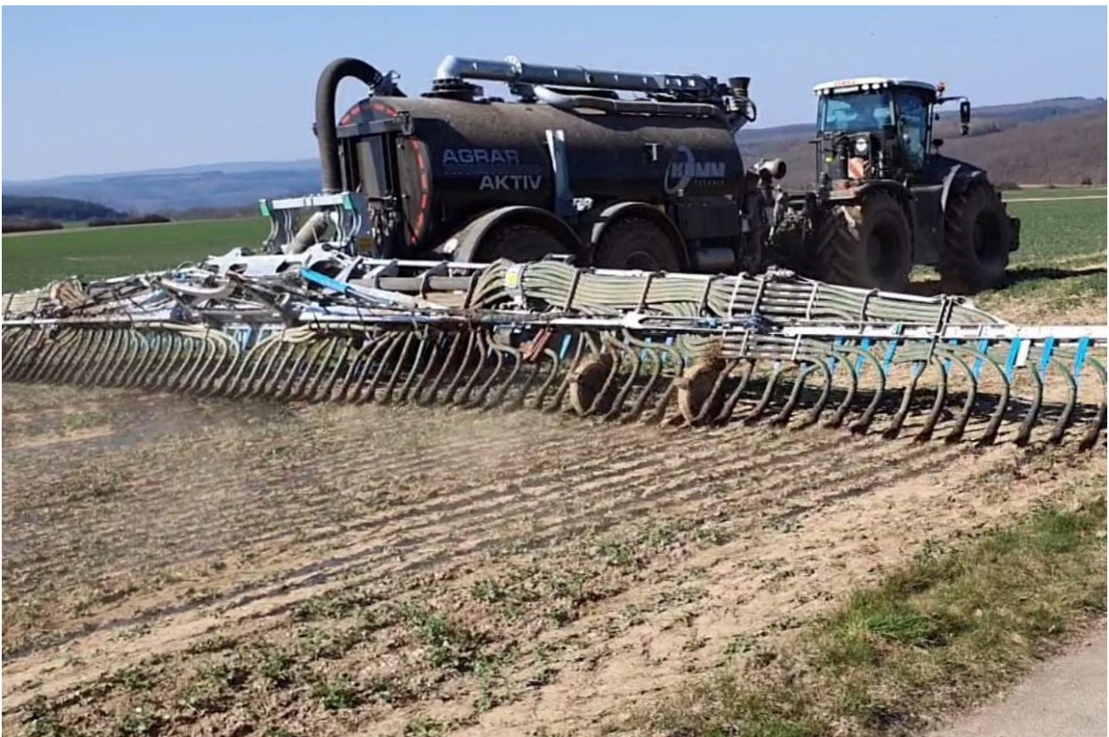
Abb. 16: Ausbringfahrzeug bei der Ausbringung von Gärprodukt zu Winterraps
