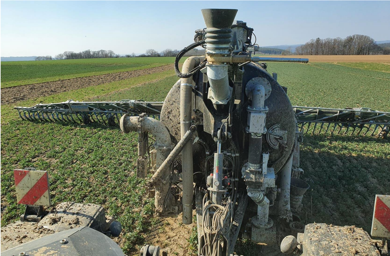
Abb. 17: Güllefass mit Schlepptschuhtechnik
