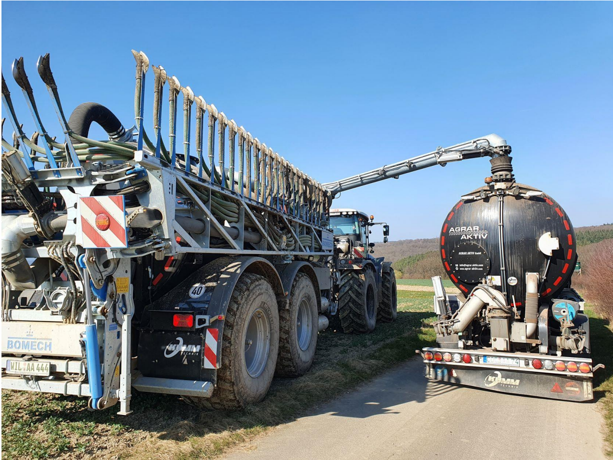
Abb. 14: Absaugen des Gärprodukts aus dem Transportfahrzeug in das Ausbringungsfahrzeug
